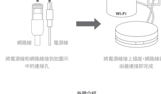
將電源線和網路線接到如圖示中的連接孔
