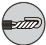
以電器用絕緣膠帶適當纏繞，避免脫落及短路
